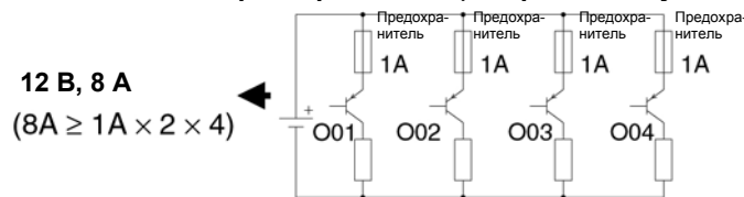
Рисунок 4.12: Пример расчета величины тока, обеспечиваемой источником, исходя из величины тока предохранителя (выбранного с учетом параметров транзистора)
