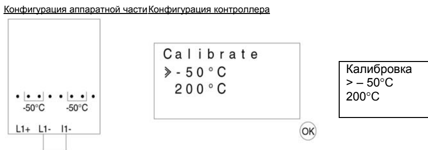
Рисунок 12.5: Регулировка смещения в модуле AL2-2PT-ADP
