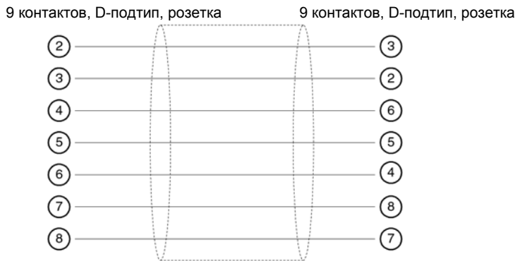
Рисунок 8.3. Схема перекрестного кабеля RS-232C, для справки
